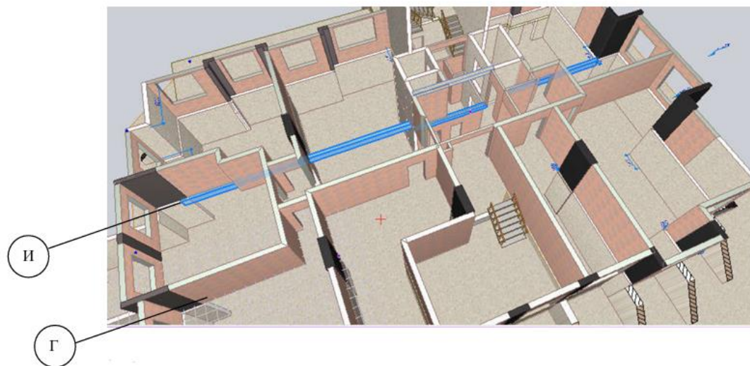
3-сурет – Ғимарат жертөлесінің үстіндегі монолитті еден арқалықтары
