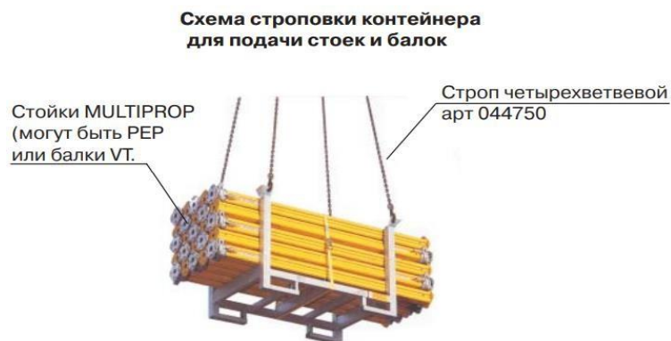
3.4-сурет. Сөрелер мен арқалықтарды жеткізуге арналған контейнердің асу схемасы.
