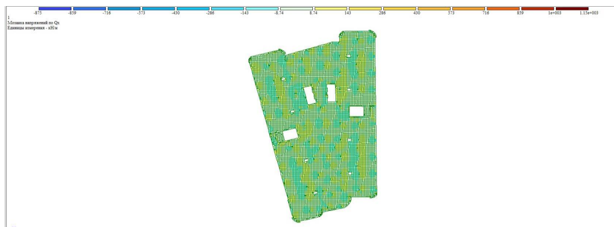
Сурет. 2.17. +20,900 деңгейіндегі еден плитасындағы Q_x күшінің изоляциясы.
