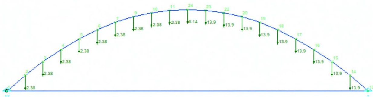
Рисунок 3.6 Вторая схема загрузки (постоянная + снег на пол пролёта), кН
