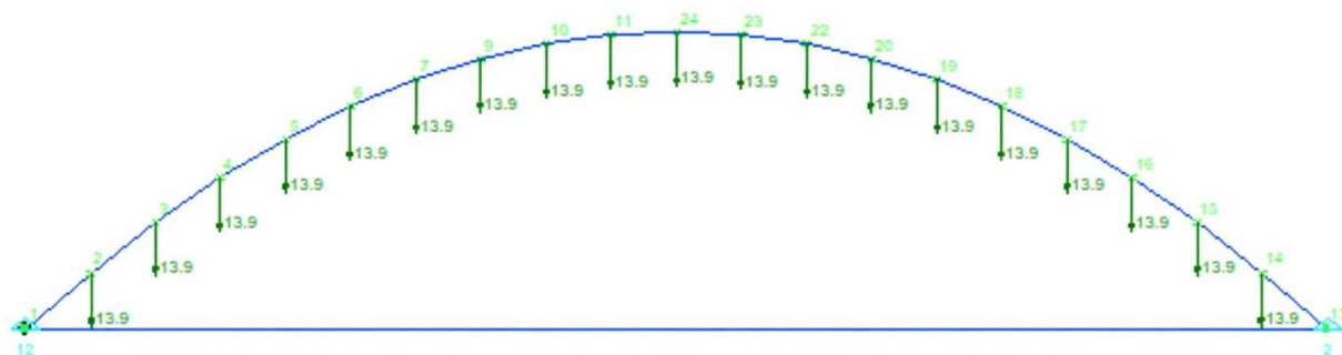
Рисунок 3.6 Вторая схема загрузки (постоянная + снег на пол пролёта), кН
