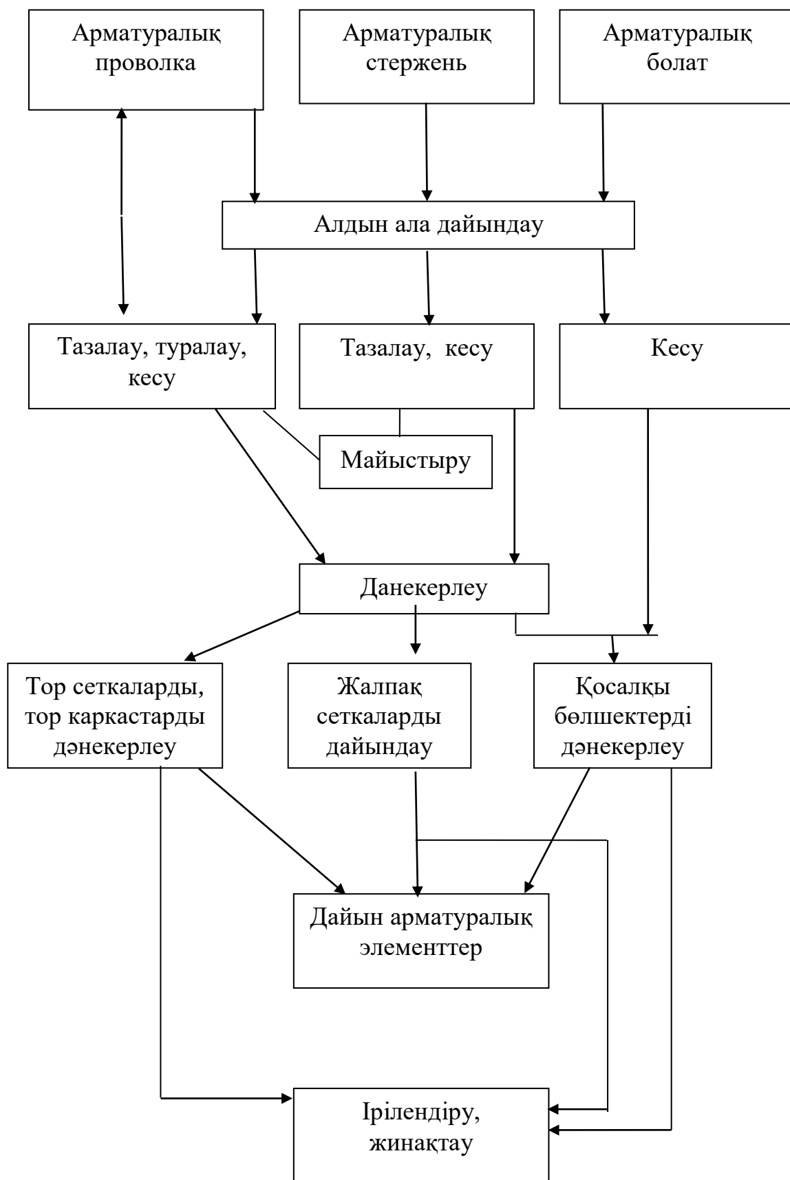
10 сурет. Арматура бұйымдары мен элементтері өндірісінің технологиялық схемасы
