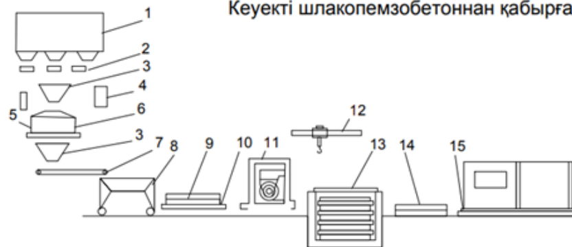
Кеуекті шлакопемзобетоннан қабырға панельдерін өндіру схемасы
