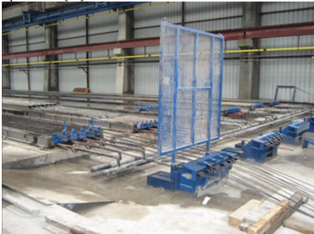
10-сурет. Арматураны топтап керуге арналған алдын ала кернеу тіректері
